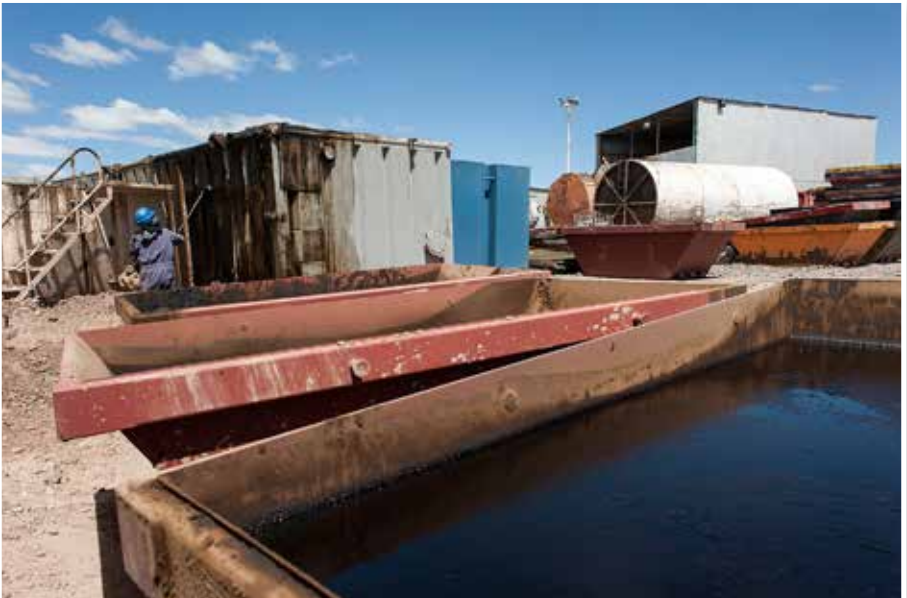
Lavado en tierra de equipos petroleros, en el basurero petrolero de Indarsa. Este procedimiento debería realizarse en lugares donde los desechos pueden luego ser tratados. | Fotógrafo: Martín Barzilai
