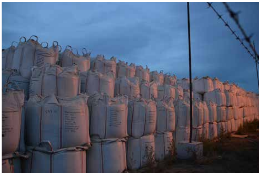
En el predio de una ex cooperativa de productores, se encuentra el depósito de arenas para fractura hidráulica que abastece hoy a Vaca Muerta. Cada saco contiene 1.5 toneladas . | Fotógrafo: Alexis Vichich
